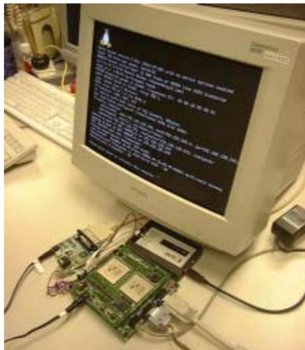
写真2. Linux/M32R ブート時のコンソール表示の様子。
